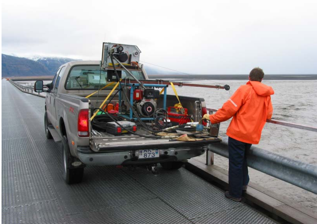
Mynd 2: Spilbúnaður sem var notaður við rennslismælingar og svifaurssýnatöku í Skeiðarárhlaupi 2004. Mynd: Gunnar Sigurðsson.
